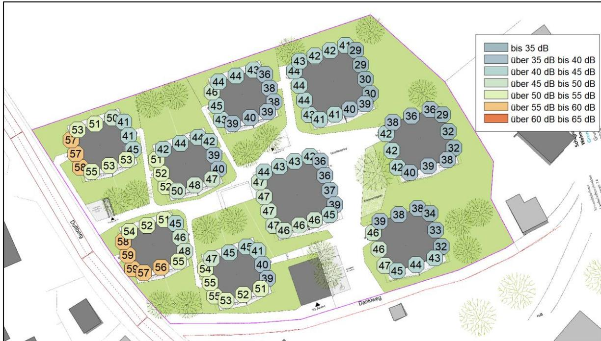
Bild 3: Verkehrslärm tags [dB(A)], Gebäudelärmkarte lautestes Geschoss
