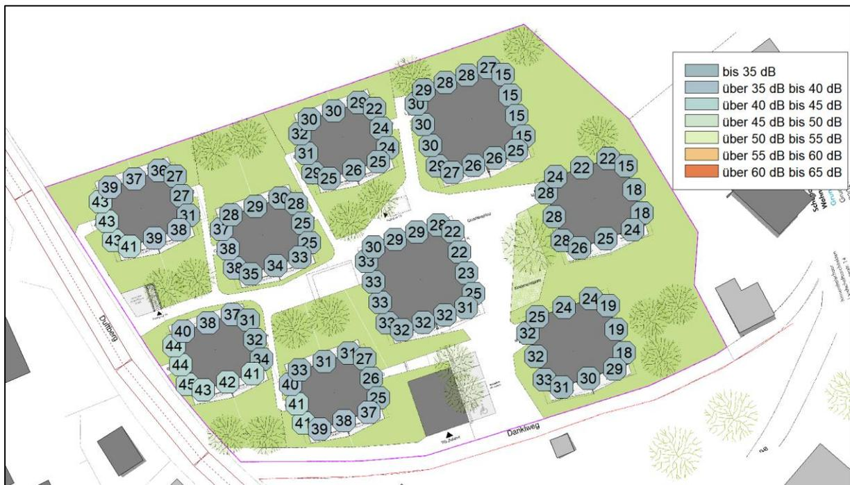
Bild 4: Verkehrslärm nachts [dB(A)], Gebäudelärmkarte lautestes Geschoss
